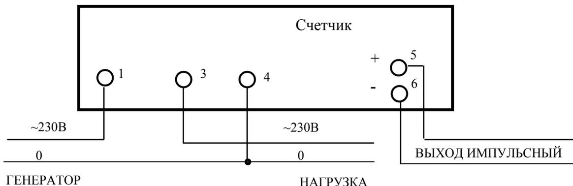
Рисунок Б.2 – Схема подключения счетчиков с шунтом СЭО-1.15.202, СЭО-1.15.402, СЭО-1.15.402/1, СЭО-1.15.402А, СЭО-1.15.402А/1
