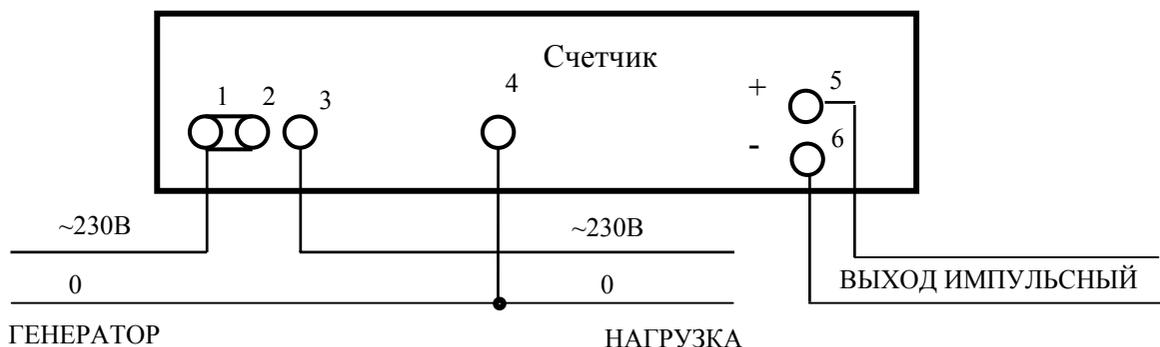
Рисунок Б.1 – Схема подключения счетчиков с токовым трансформатором и комбинированным измерителем тока СЭО-1.15.102, СЭО-1.15.202, СЭО-1.15.302, СЭО-1.15.302А, СЭО-1.15.302/1, СЭО-1.15.302А/1, СЭО-1.15.502, СЭО-1.15.502/1, СЭО-1.15.502А, СЭО-1.15.502А/1, СЭО-1.15.602
